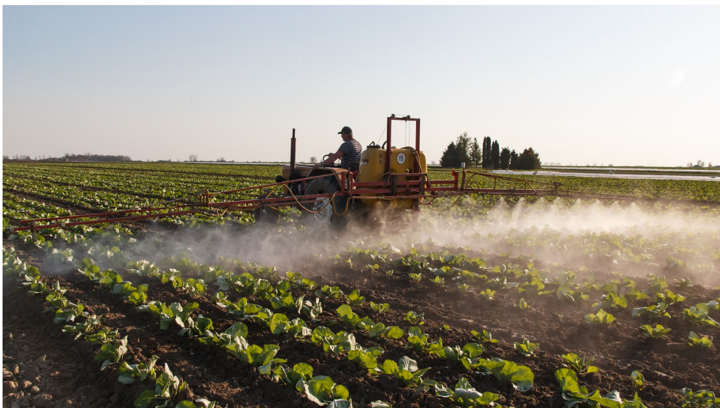
6. Pulverizadora agrícola trabajando sobre hileras de cultivo: el manejo eficiente requiere revisar presión, caudal, velocidad de avance y estado general del sistema de aplicación.
