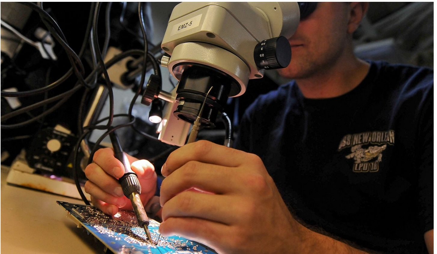
Foto 8 Soldadura de un microchip con apoyo de microscopio, procedimiento habitual en reparación de componentes pequeños.
