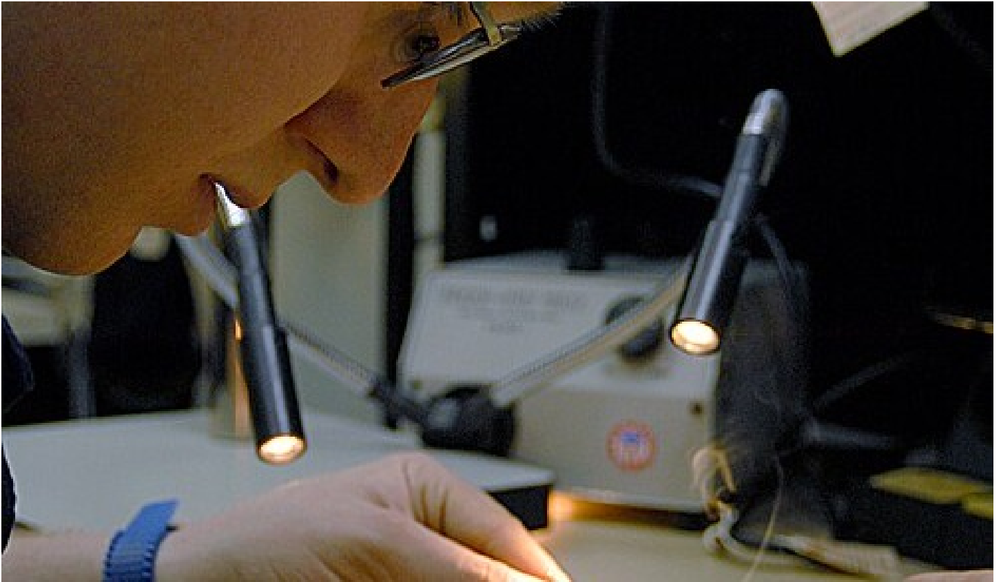
Foto 7 Trabajo detallado sobre una placa electrónica bajo iluminación focalizada para inspeccionar y corregir conexiones.
