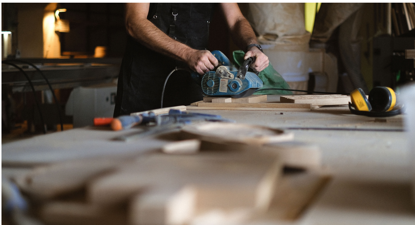
6. Cepillado y rebaje de piezas. Una herramienta eléctrica portátil permite regularizar superficies y ajustar espesores para lograr uniones más precisas durante la fabricación del mueble.
