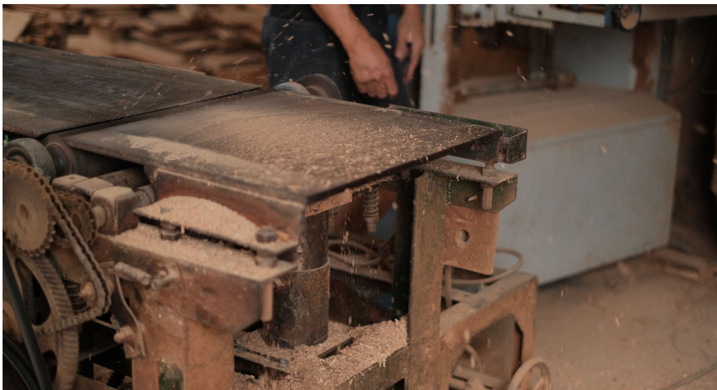
5. Máquinas fijas para el mecanizado de la madera. La fotografía permite reconocer equipos de corte y cepillado, además de la presencia de aserrín como riesgo que exige limpieza y protección respiratoria.
