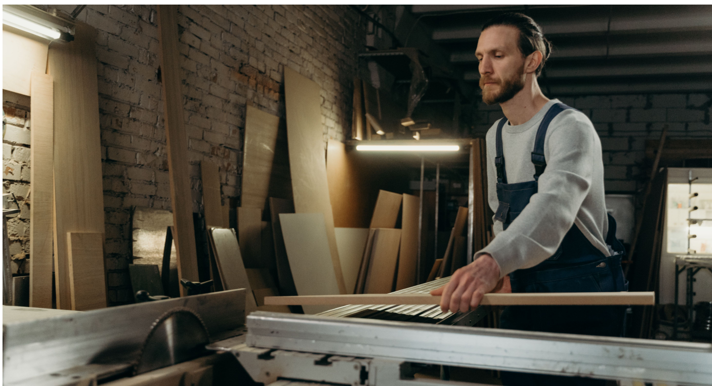
10. Corte preciso en sierra de mesa. El operario guía una pieza longitudinal con atención, aplicando técnicas de trazado, sujeción y avance controlado para obtener componentes uniformes.
