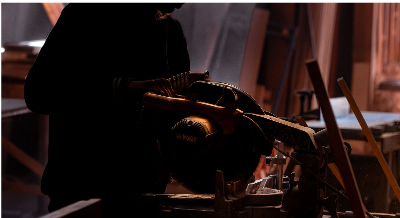
4. Corte con maquinaria eléctrica. El uso de una sierra requiere controlar la posición de la pieza, mantener la zona despejada y aplicar medidas de protección para evitar accidentes.
