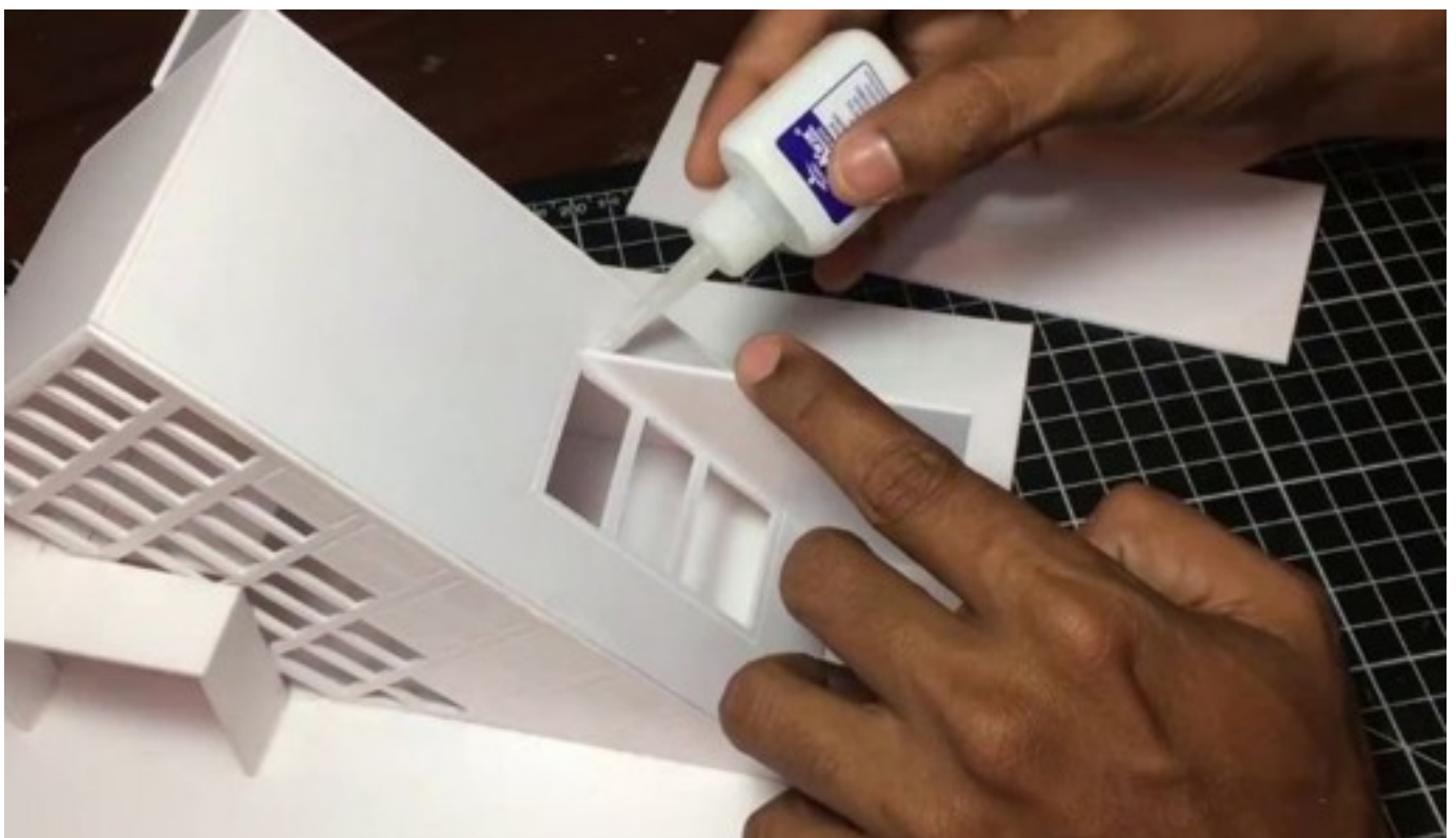
6. Ensamble y pegado: la aplicación controlada de adhesivo y la correcta alineación de las piezas permiten mantener escuadras, estabilidad y limpieza visual durante la construcción.
