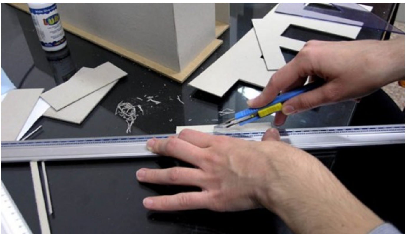
4. Técnicas de corte de precisión: el uso de cúter, regla y una superficie firme permite obtener piezas rectas, limpias y compatibles con la escala elegida para la maqueta.
