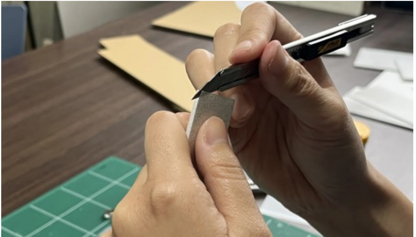
5. Preparación de piezas pequeñas: controlar el ángulo del corte y el espesor del material es clave para lograr uniones prolijas en muros, bordes, ventanas y detalles.
