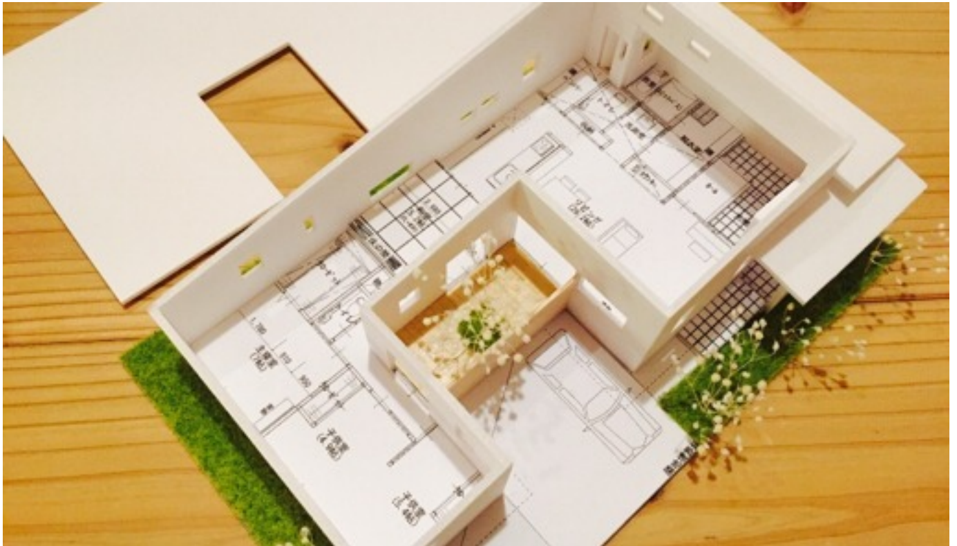
7. Relación entre planos y maqueta: las plantas arquitectónicas sirven de guía para ubicar muros, aberturas, circulaciones y proporciones dentro del modelo tridimensional.
