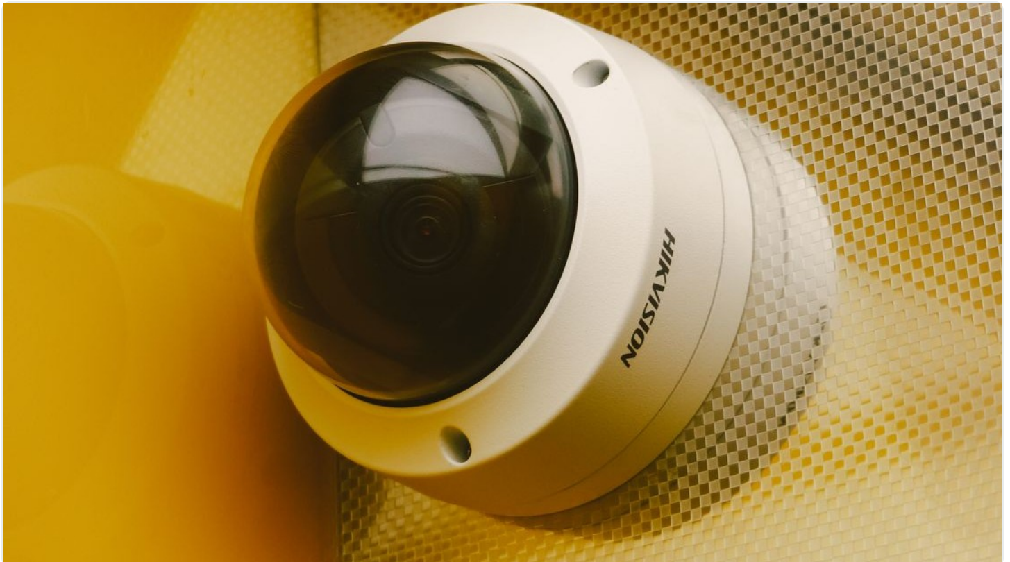
4. Cámara domo de alta definición utilizada en sistemas CCTV para supervisión continua de interiores, comercios, edificios e instalaciones industriales.
