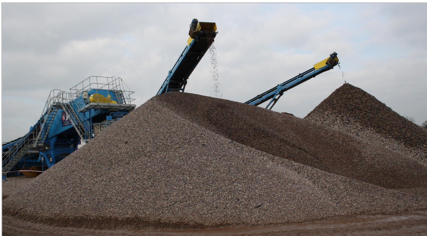
Foto 9. Producción de distintas fracciones de áridos reciclados. El control de calidad permite verificar tamaño, limpieza y aptitud de los materiales recuperados antes de su reutilización.
