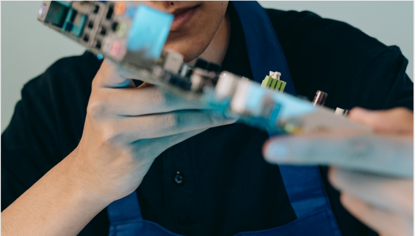
Foto 3 Inspección visual de una placa madre: reconocimiento de circuitos, conectores y componentes antes de una reparación.
