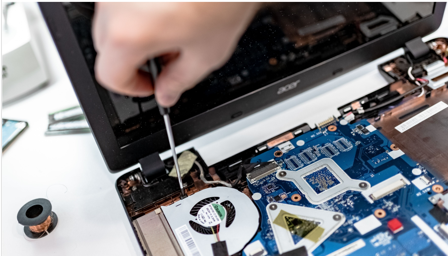
Foto 5 Desarme de notebook: acceso a placa, sistema de refrigeración y componentes para diagnóstico y mantenimiento del equipo.
