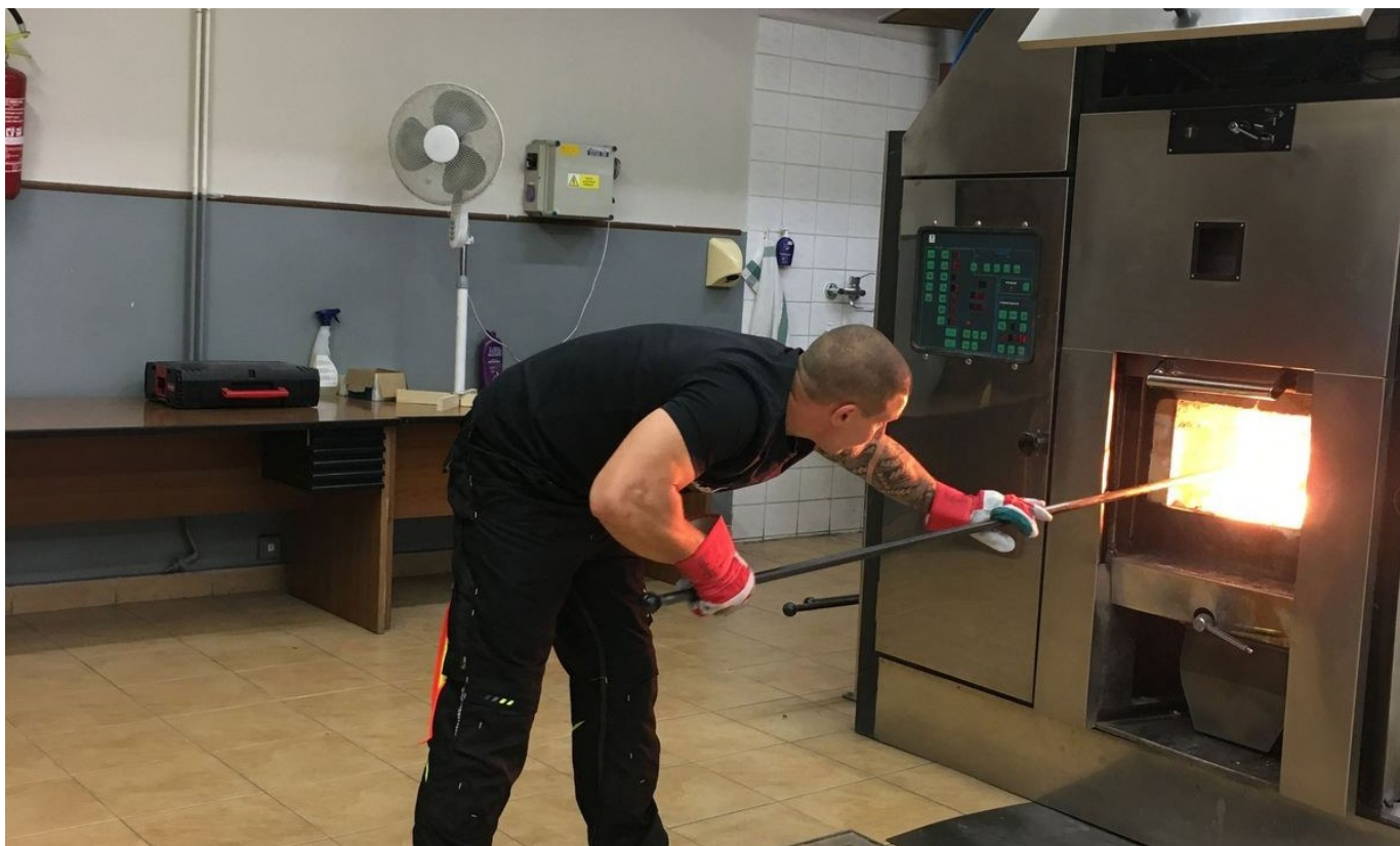
Foto 1. Operación técnica de un horno crematorio: muestra el trabajo del personal frente a equipos de alta temperatura y el uso de herramientas largas para intervenir de forma segura durante el proceso.
